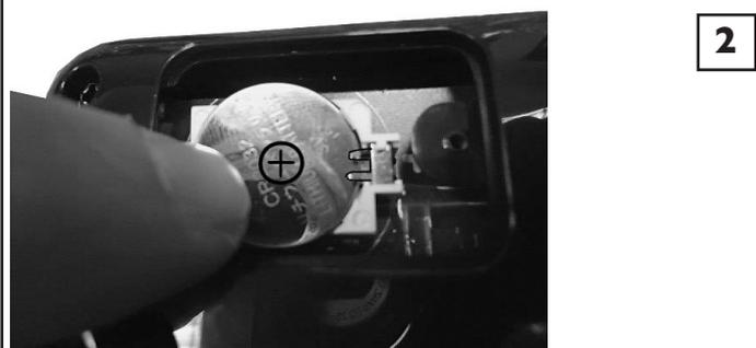
Dopo aver sostituito la batteria chiudere il portello **B** e fissarlo con la vite **A**, quindi fissare nuovamente il computer nell'apposita staffa di bloccaggio sul manubrio tramite le quattro viti filettate.
