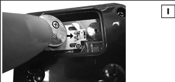
**2.** Dopo aver collegato il terminale positivo premere sulla batteria in modo da collegare il terminale negativo.
